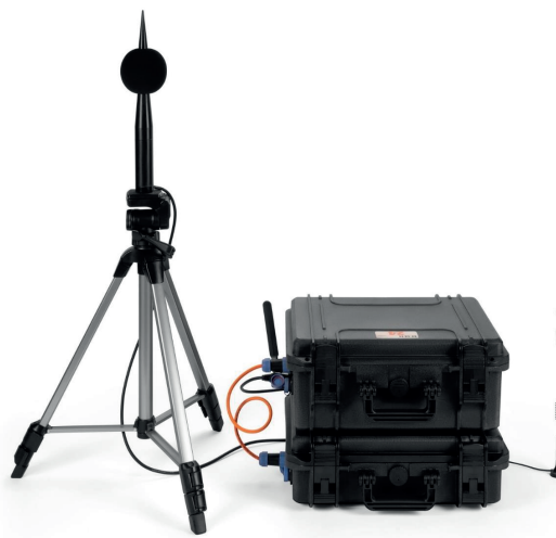
Рис. 4. Всепогодное исполнение мобильного комплекса ECOFLIGHT 14.11
